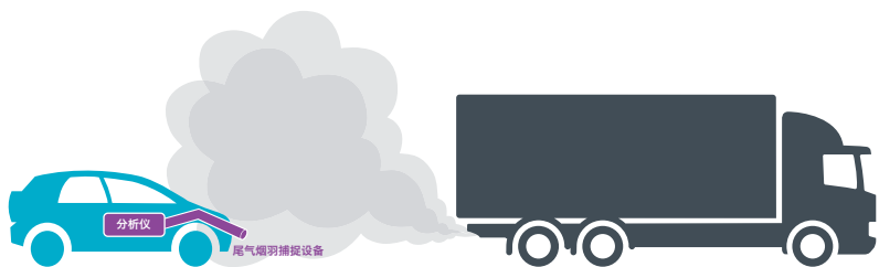
尾气烟羽跟车遥感设备示意图
