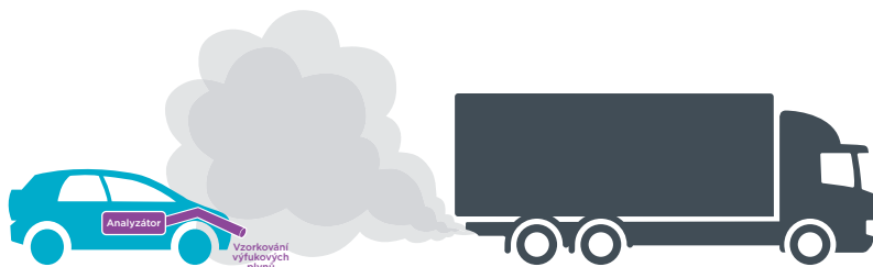
Schéma zařízení bezkontaktního měření pomocí sledovacího vozidla vzorkujícího výfukové plyny
