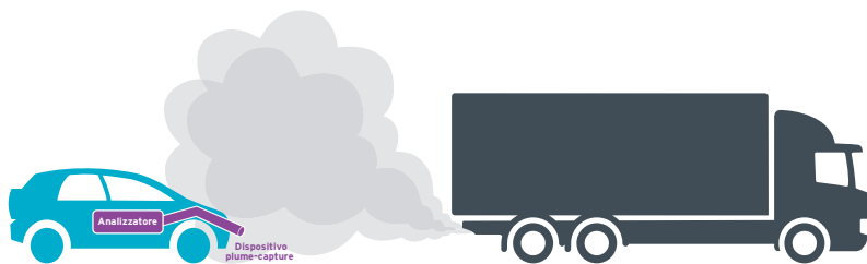
Dispositivo di remote sensing di tipo plume-chase per le emissioni veicolari
