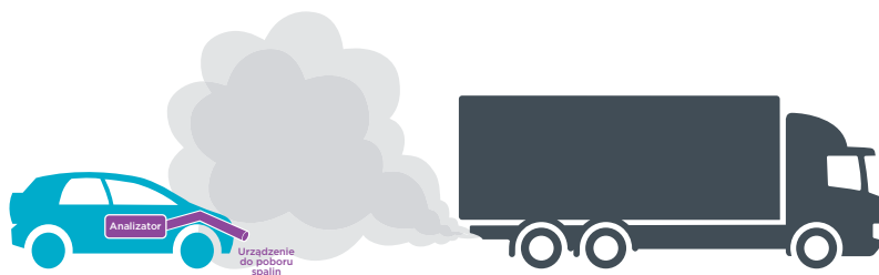
Schemat urządzenia teledetekcyjnego kontrolującego emisje zanieczyszczeń w strumieniu spalin pojazdu.
